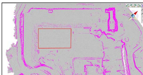
写真1 デジタル画像処理による シート敷設面の平坦性確認
